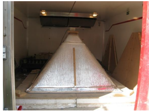
Fig. 4 Aluthermo Quattro ® applied over rafter
